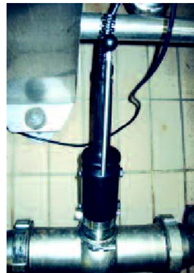
Ilustracja 1: Armatura wymienna InTrac 777 zamontowana w obudowie Tuchenhagen Varivent®
