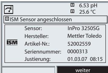
Automatisch werden alle sensortypischen Parameter an das Meßgerät übermittelt. Das betrifft zum Beispiel Meßbereich, Nullpunkt und Steilheit des Sensors, aber auch den Temperaturfühlertyp. Ohne jede weitere Parametrierung wird sofort gemessen, die Meßtemperatur wird simultan erfaßt. Vorgemessene ISM-Sensoren können per "Plug&Measure" ohne Kalibrierung am Gerät sofort in Betrieb genommen werden.
